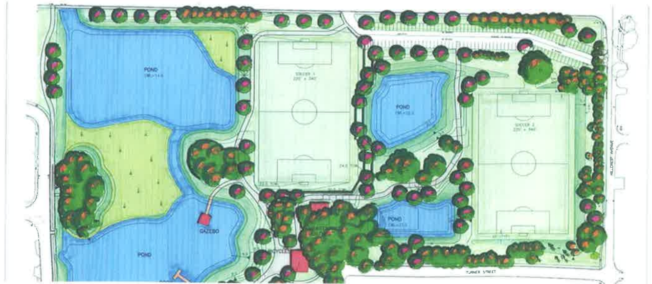
Şekil 9. Örnekte görüldüğü gibi spor alanları çevresinde yer alan göletler, geniş teraslardan gelen yüzey akışlarının depolanması yanında rekreasyonel amaçlarla da kullanılmaktadır.
