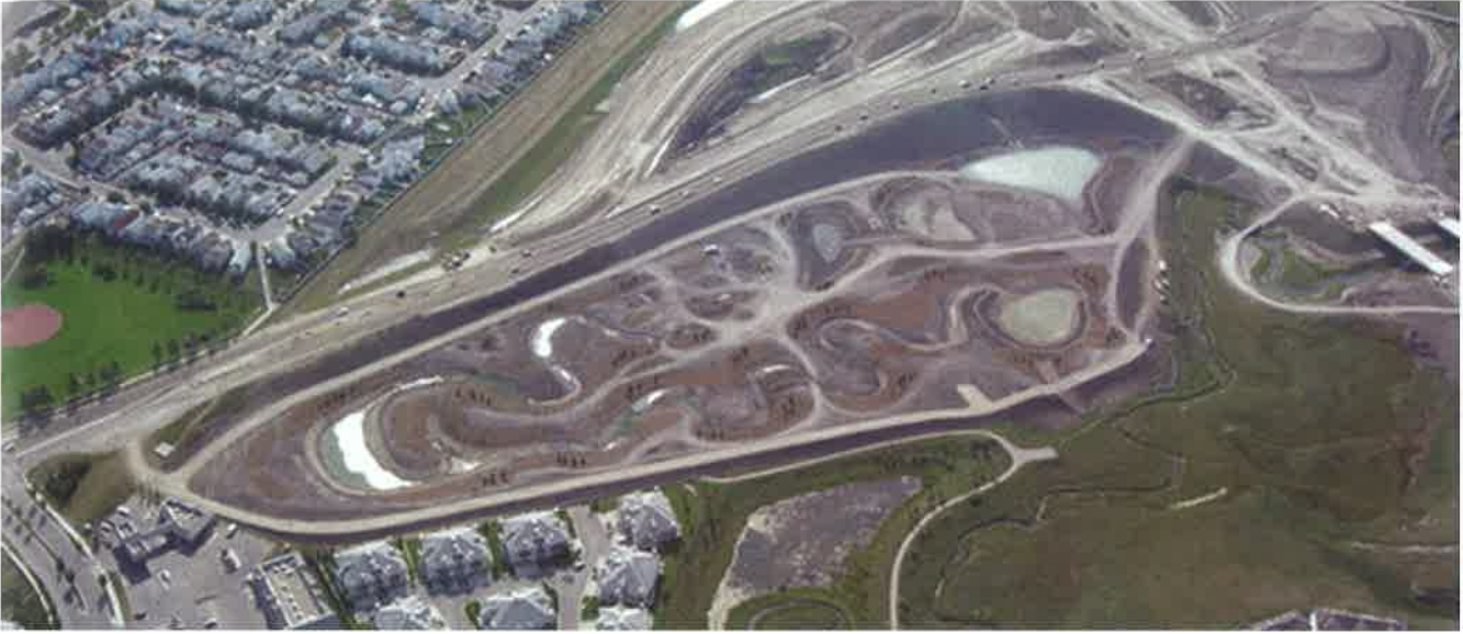
Şekil 6. Yoğun konut alanları çevresinde yüzey sularının toplanmasını sağlayacak göletler tasarlanarak yüzey suyunun doğrudan doğal akarsu ve göllere akması engellenir.
